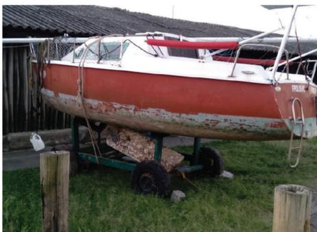
Imagem 31: Veleiro particular estacionado ao redor do Rancho de Pesca. Observa-se o Leme no fundo do casco, responsável pelo rompimento do material de pesca. Fonte: Autor
