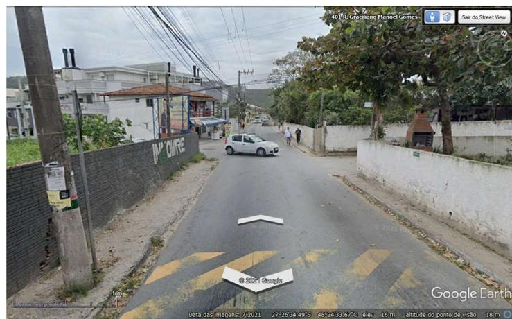
Figura 7 - Ponto D - Poste reduzindo o espaço de circulação de pedestres. Calçada estreita.
