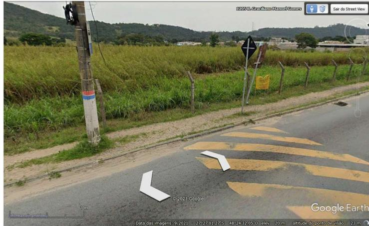
Figura 12 - Ponto I - Falta calçada. Poste e placa de sinalização no espaço de circulação dos pedestres.
