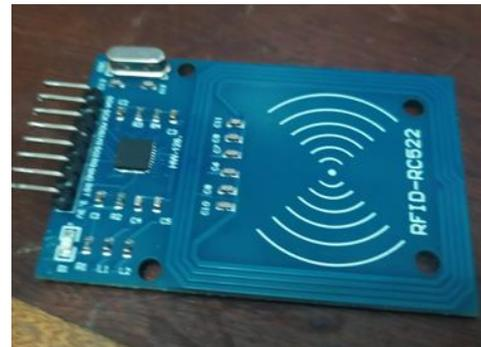
Figura 15 - Foto do Leitor NFC RFID-RC522. Fonte: Autoria Própria, 2022.
