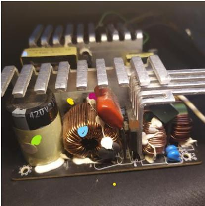
Figura 19 - Fonte ATX 450W com PFC Ativo. Fonte: Autorial Própria, 2022.
