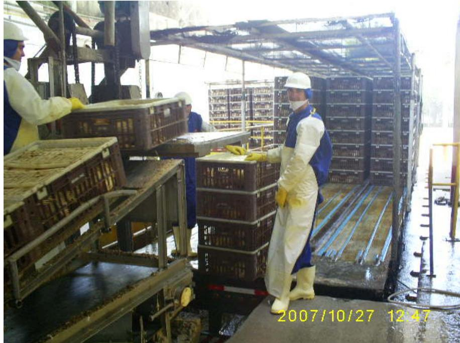
Figura 7 – Nivelamento das gaiolas com a esteira
