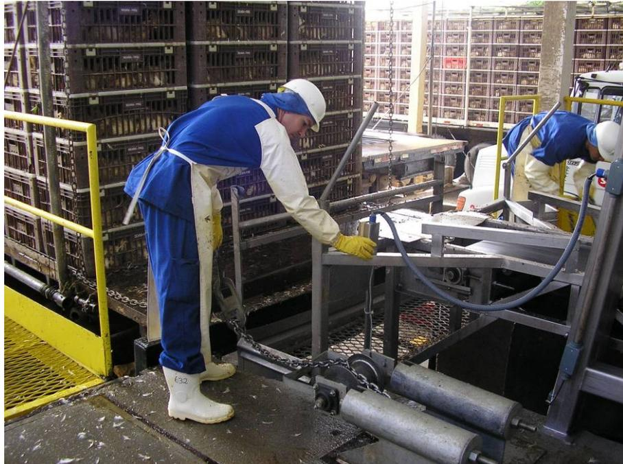
Figura 11 – Sistema de tração no início da carga
