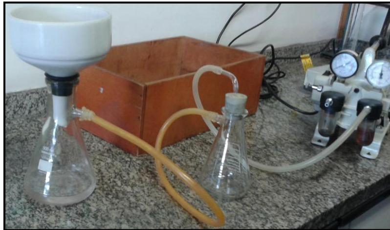
*Figura 9: Sistema de filtragem a vácuo.*
