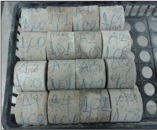
Figura 32: Cilindros de argamassa de 50 mm.
