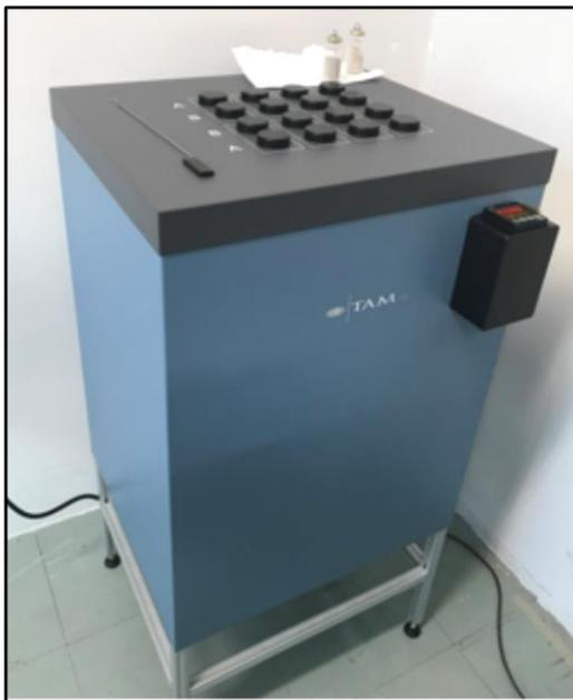
*Figura 50: Calorímetro TAM Air.*
