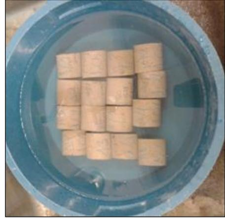
Figura 33: Cilindros de argamassa submersos.
