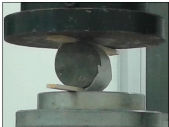
Figura 38: Ruptura diametral.
