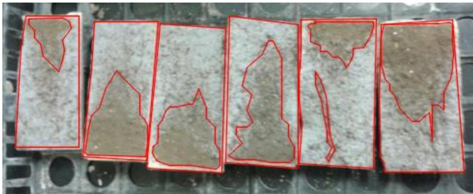
*Figura 62: Corpos de prova submetidos à migração de cloretos no período de 72 horas, por capilaridade.*
