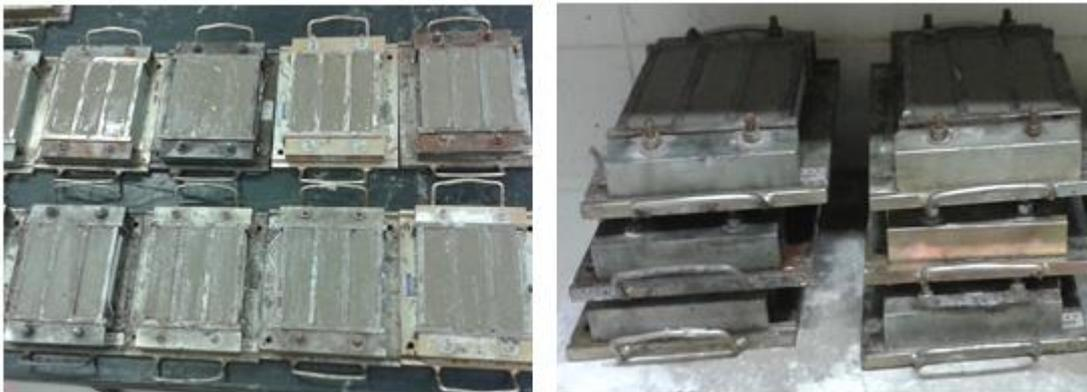
*Figura 27: Moldagem corpos-de-prova prismáticos (40x40x160mm).*
