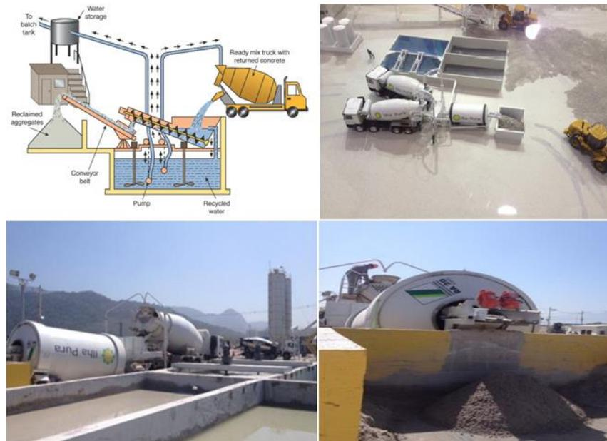
*Figura 3: Diagrama esquemático e exemplo de uma obra que faz uso do reciclador em substituição ao bate-lastro, eliminando efluente. Arquivo pessoal.*
