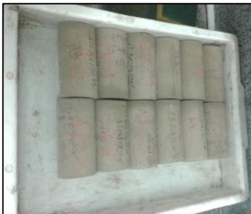
Figura 48: Corpos-de-prova submersos.
