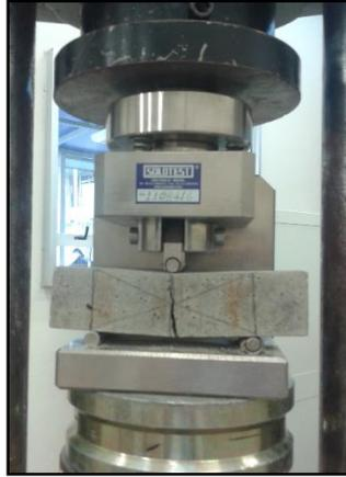
*Figura 29: Ensaio de resistência à tração na flexão.*
