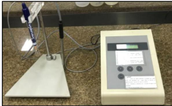
*Figura 21: Condutivímetro de Bancada.*
