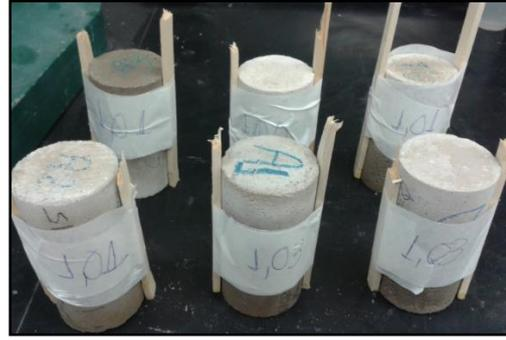
Figura 43: Ensaio de Absorção por capilaridade. Figura 44: Amostras para rompimento diametral.
