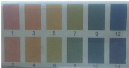
Figura 17: Escala comparativa para as faixas de pH da água.
