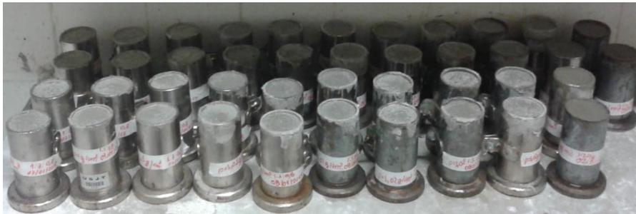
*Figura 28: Moldagem corpos-de-prova cilíndricos (50x100mm).*
