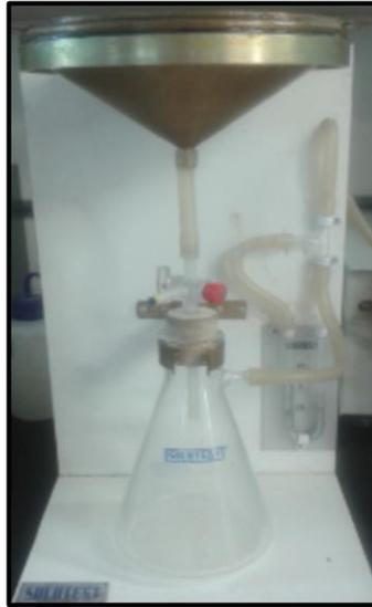
*Figura 24: Aparelho utilizado para realização do ensaio de retenção de água.*
