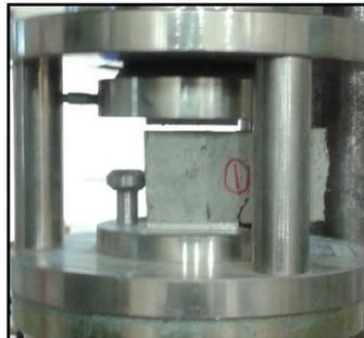
*Figura 30: Ensaio de Resistência à Compressão.*
