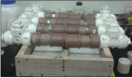
Figura 34: Aparato do ensaio de migração.
