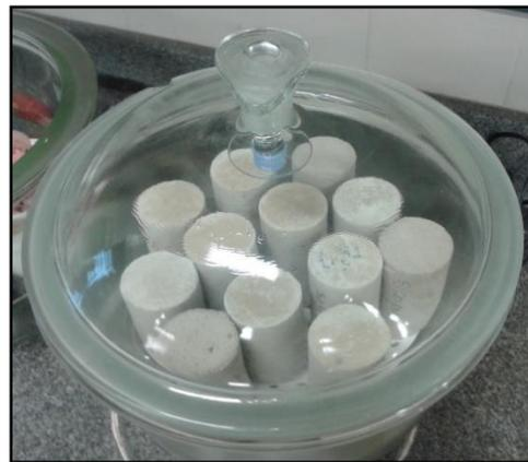
*Figura 42: Corpos-de-prova no dessecador.*
