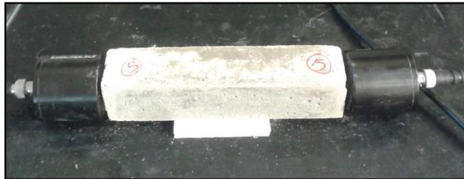
Figura 31: Medida do módulo de elasticidade dinâmico.
