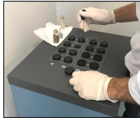
Figura 53: Colocação amostras no calorímetro.
