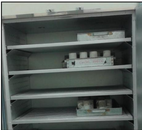
*Figura 41: Corpos-de-prova secando na estufa.*
