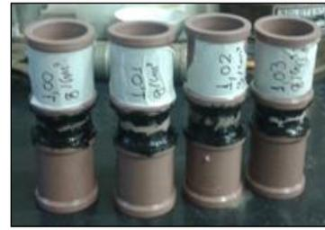
Figura 35: Vedação e encaixe das amostras
