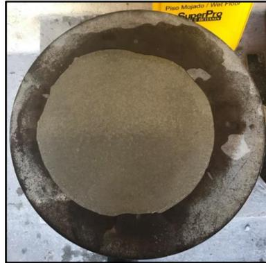
*Figura 25: Mesa de consistência – ensaio de espalhamento.*
