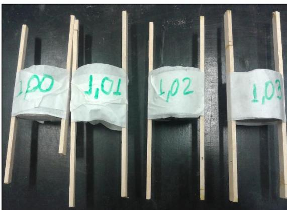
Figura 37: Amostras prontas para ruptura diametral.
