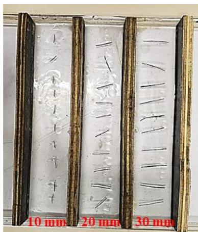
Figura 17. Resultado da ação do campo magnético em vários tamanhos de fibras revestidas no gel.
