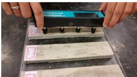
Figura 23. Ensaio de resistividade nos compósitos.
