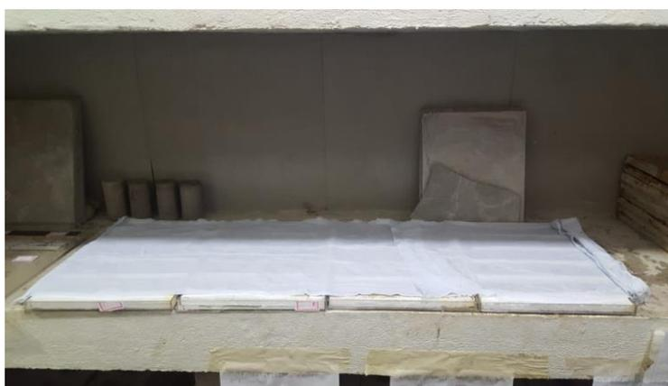
Figura 22. Amostras em câmara úmida após processo de moldagem.
