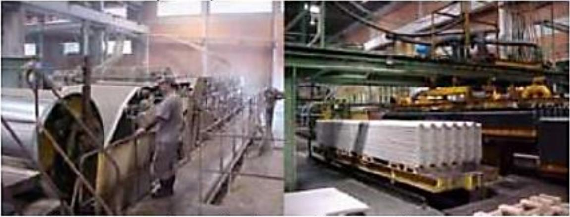
Figura 3. Método *Hatschek* para produção de placas planas e telhas onduladas(a); máquina formadora e desenforme (b).
