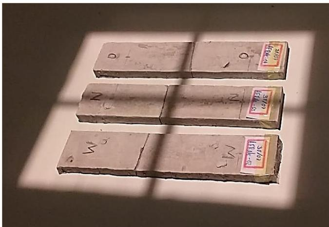
Figura 30. Amostras do lote CC\_S\_IN\_RA, CC\_S\_R\_RA e CC\_S\_R\_OR sendo submetidas à radiografia.
