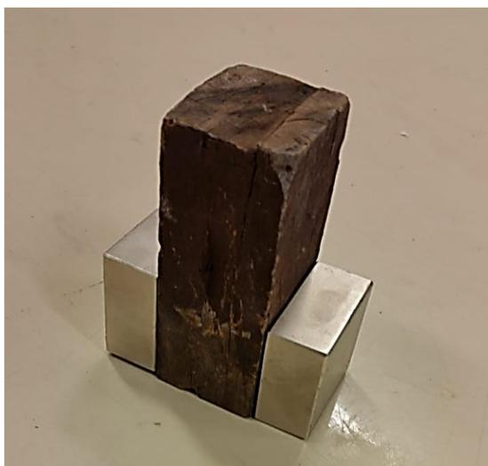
Figura 15. Imãs de neodímio separados por um bloco de madeira.
