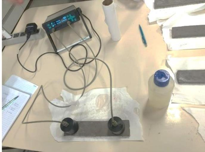
Figura 25. Ensaio para determinação da velocidade do pulso ultrassônico.
