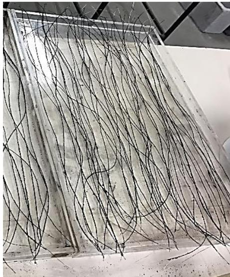
Figura 13. Fibras de sisal revestidas com o adesivo *Compound Gel* e partículas ferromagnéticas.
