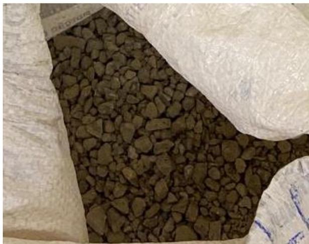
Figura 29 - Agregado reciclado após britagem (AUTOR, 2020).
