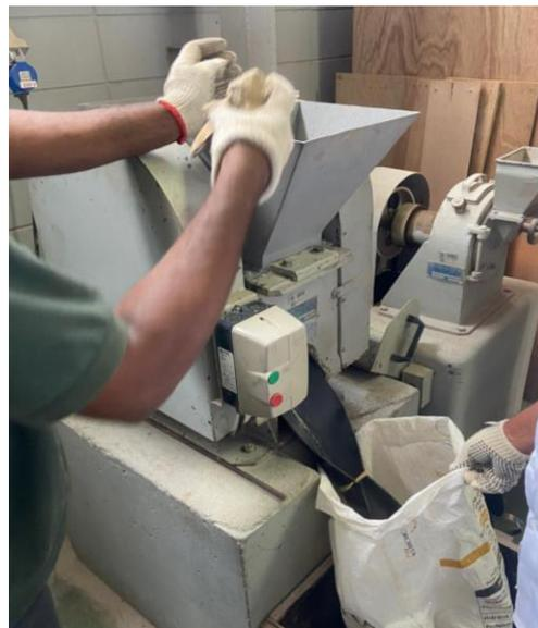
Figura 28 - Material sendo britado e retornando ao saco (AUTOR, 2020).
