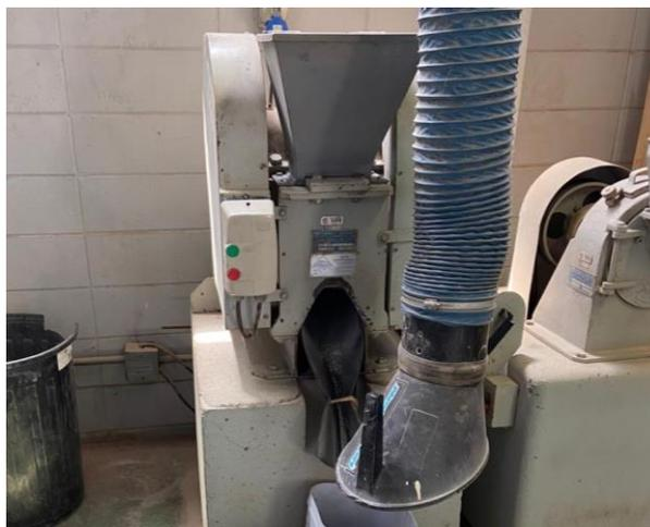
Figura 23 - Britador elétrico da ABCP (AUTOR, 2020).
