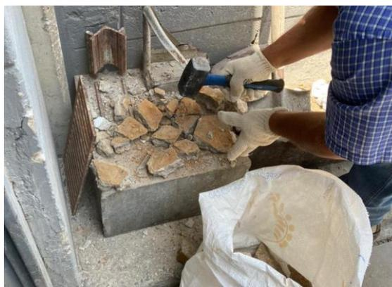
Figura 26 - Fracionamento da amostra de RCD (AUTOR, 2020).
