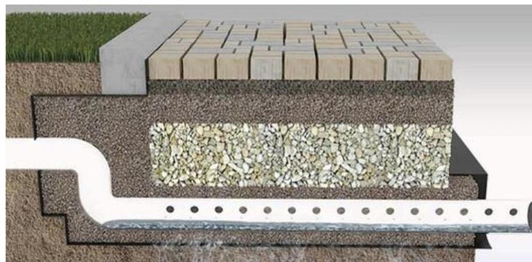
Figura 8 - Camadas de pavimentação permeável esquematizada (ARCH DAILY, 2019).
