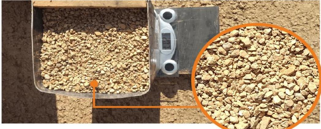
Figura 6 - Agregado reciclado (ARQXP, 2020).
