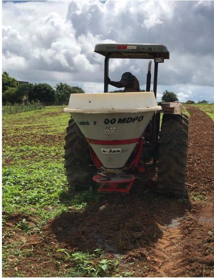
**Figura 4:** Lançador utilizado no manejo agrícola para distribuição de adubos químicos no solo.
