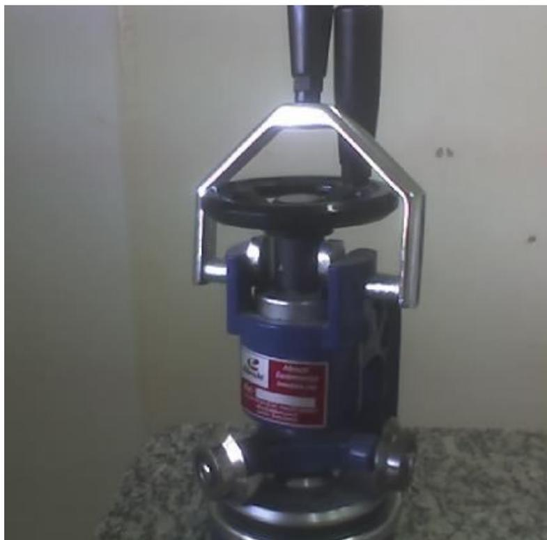
Figura 17 - Máquina cortadora de bolacha de gramatura
