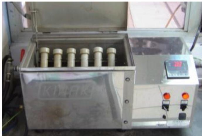
Figura 16 – Máquina de Lavação para Solidez.
