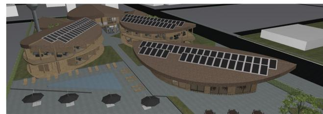
Serão instaladas 102 placas fotovoltaicas na cobertura do restaurante, e nos dois blocos de hospedagem. Estrategicamente posicionadas com uma inclinação de 28° voltadas 30° para nordeste e noroeste. O posicionamento das placas fotovoltaicas garante a captura de luz solar ao longo do dia, otimizando a produção de energia limpa e renovável.
