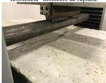
(i) Imagens da ruptura das placas do Grupo A. Detalhe da ruptura da viga (PL 1).
