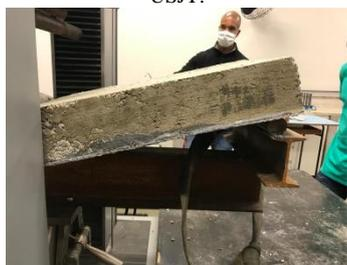
(c) Imagens da ruptura das placas do Grupo C. Detalhe da viga (PL 7) após a ruptura nota-se a fragilidade no momento de ruptura.
