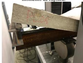
(h) Imagens da ruptura das placas do Grupo B. Detalhe da placa (PL 06) após a ruptura nota-se um aumento de resistência no momento de ruptura.
