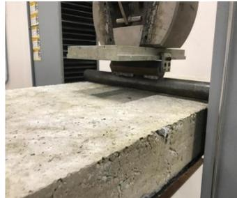
(f) Imagens da ruptura das placas do Grupo B. Detalhe da placa (PL 04) após a ruptura nota-se um aumento de resistência momento de ruptura.
