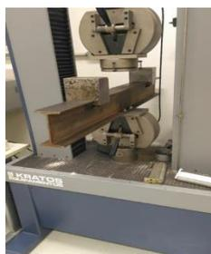
(a) Prensa com dispositivo desenvolvido especificamente para este ensaio pelo próprio laboratório da mecânica da USJT.
