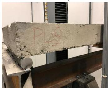
(e) Imagens da ruptura das placas do Grupo C. Detalhe da viga (PL 7) após a ruptura nota-se a fragilidade no momento de ruptura e com baixa ductilidade.
