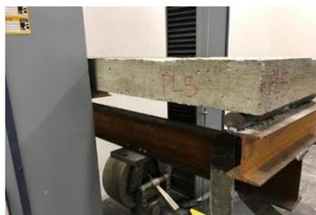
(g) Imagens da ruptura das placas do Grupo B. Detalhe da viga (PL 04) após a ruptura nota-se um aumento de resistência momento de ruptura.
