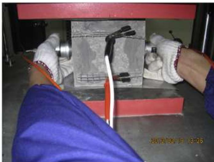
Figura 2-12- Método de teste simultâneo DC e ultrassom. (Fonte [43])
