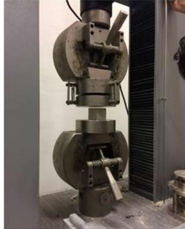
Figura 4-9- Ensaio de compressão axial simples com corpos-de-prova cúbicos.
