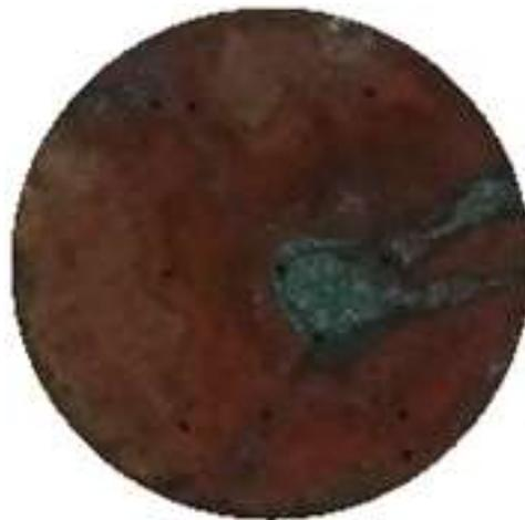
Figura 4-3- Eletrodo circular oxidado.
