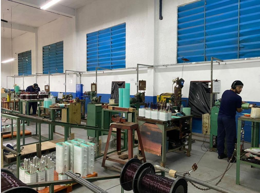
Figura 07 - Foto do setor de bobinamento, autorizada pela empresa UpTrafos (Cotia – 2022)
