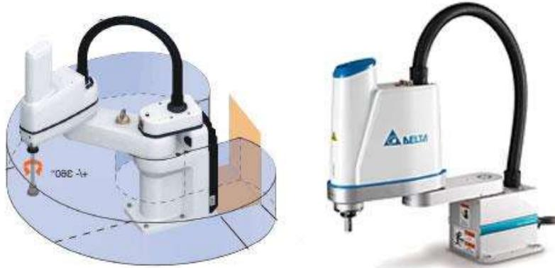
Figura 3– Robô SCARA (Fonte: <https://www.citisystems.com.br>)
