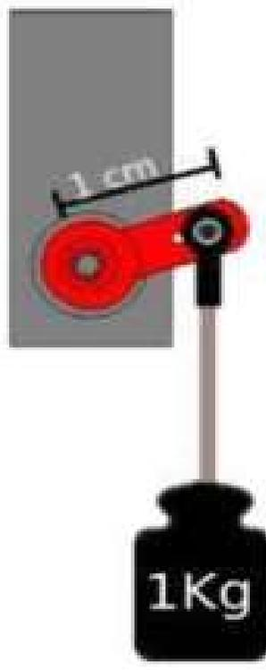
Figura 34 - Servo motor submetido a um torque de 1 kg-cm (Fonte: <https://eletroeletronicaetec.wordpress.com>)
