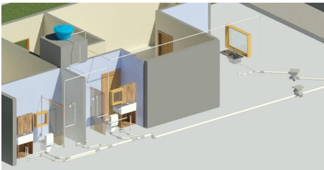
Figura 2: Projeto de Hidráulica no Revit. Autores (2023).
