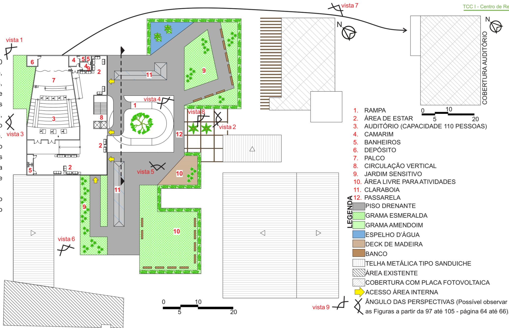
A cobertura do restaurante e do auditório será apoio para as placas fotovoltaicas que abastecerão todo o Centro de Reabilitação Física. A água da chuva será captada e será destinada à cisterna localizada no subsolo.
