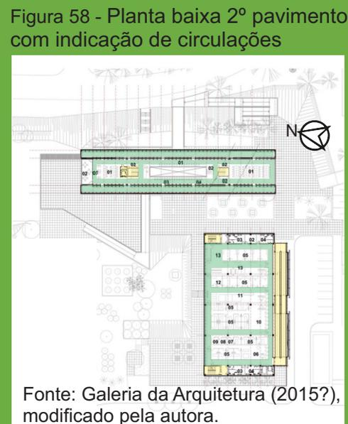
Figura 58 - Planta baixa 2º pavimento com indicação de circulações
