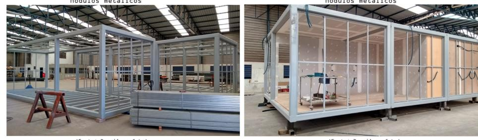
Após conclusão da obra dentro da fábrica, os módulos são içados e colocados nos caminhões plataforma, levados até o terreno e instalados, esse processo leva em média de 1 a 2 dias, dependendo do tamanho e complexidade da obra.
