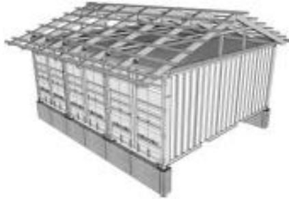
Figura 25: Estrutura para instalação de cobertura em uma edificação feita em container.
