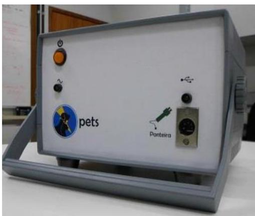
**Figura 2** – Gerador de pulsos desenvolvido pela Universidade Federal de Minas Gerais (Fonte: UFMG)
