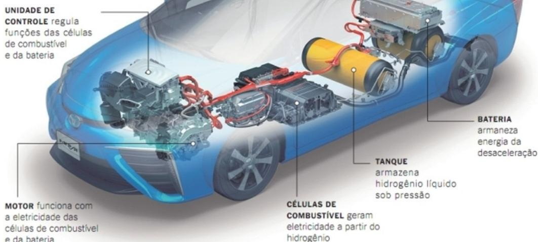
Figura 20 – Principais componentes do Toyota Mirai
