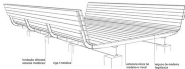
Figura 61: Axonométrica deck de madeira.
