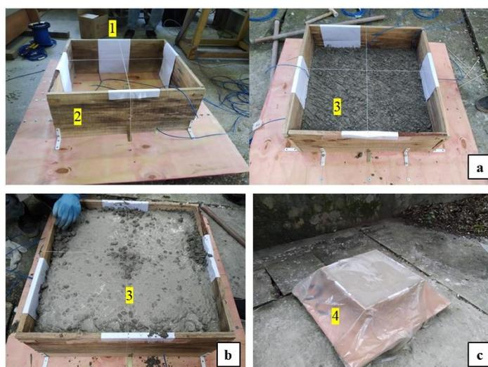
Figura 23 – Processo de moldagem e cura dos corpos de prova de concreto: (a) preenchimento da primeira camada de concreto e esscarificação da superfície; (b) preenchimento da última camada de concreto (c) colocação da lona plástica.
