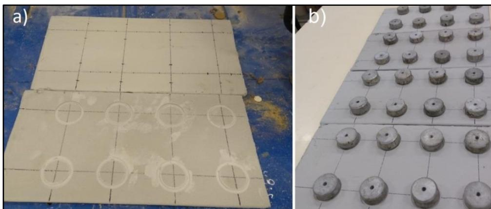
O ensaio de resistência de aderência à tração foi realizado 14 dias após a aplicação das argamassas, com o auxílio de um dinamômetro de pressão da marca PosiTest, modelo AT-M Manual (Figura 30-a). As resistências de aderência à tração foram lidas no próprio equipamento (Figura 30-b), e corrigidas em função dos diâmetros reais dos corpos de prova (o equipamento efetua o cálculo de resistência de aderência à tração em MPa e considera diâmetro de 50mm para todos os corpos de prova).
