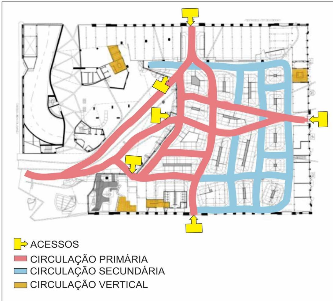
**Figura 23** - Planta baixa com indicação de acessos e fluxos
