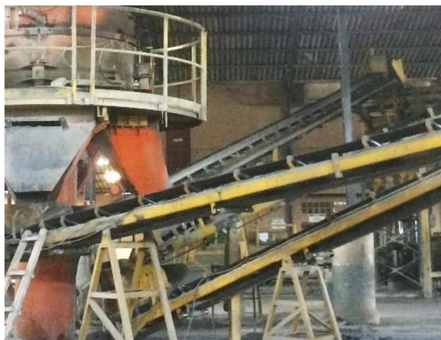
Figura 31 - Transporte do concreto do misturador para o molde na máquina de vibro-compressão, a partir do uso de esteiras rolantes.
