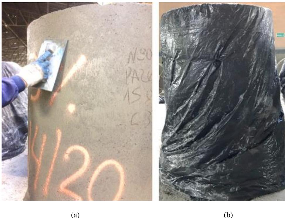
Figura 23 - Produção de tubos de concreto: (a) acabamento final com auxílio de desempenadeira e (b) cobertura do tubo com lona plástica após o acabamento.
