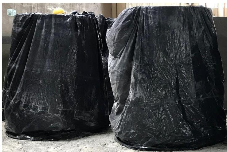
Figura 32 - Processo de cura de tubos de concreto com cobertura de lona plástica após o acabamento.
