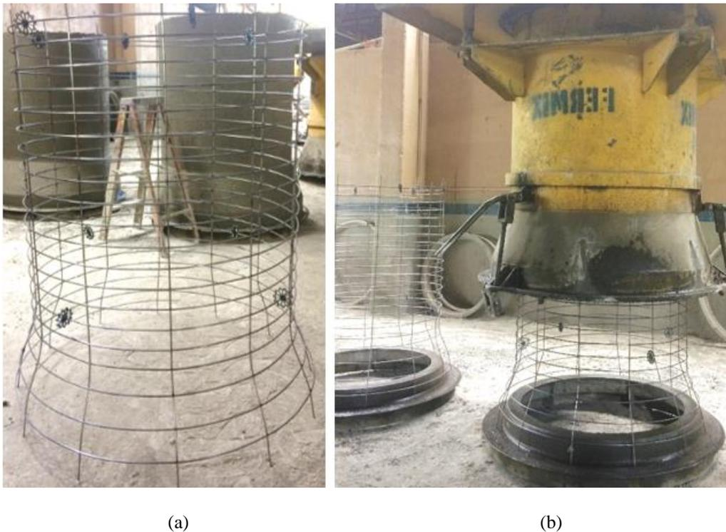
Figura 28 - Etapas prévias para a produção de tubos de concreto: (a) montagem do reforço de aço; (b) fixação do reforço de aço no molde.
