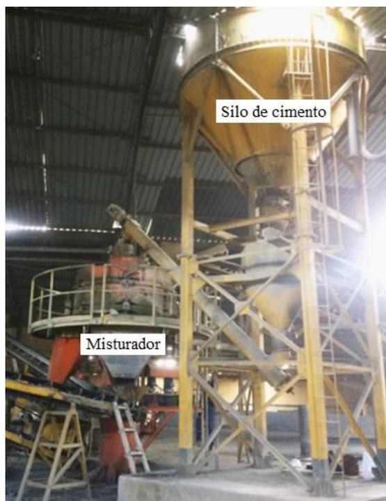
Figura 30 - Silo de cimento gravitacional posicionado sobre o misturador para a fabricação de tubos de concreto.
