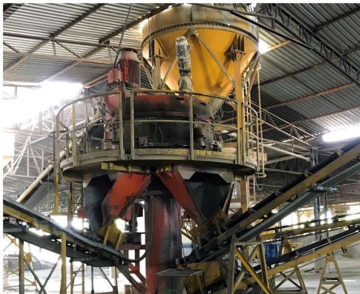
Figura 20 - Lançamento do cimento no misturador para a produção do concreto para tubos.
