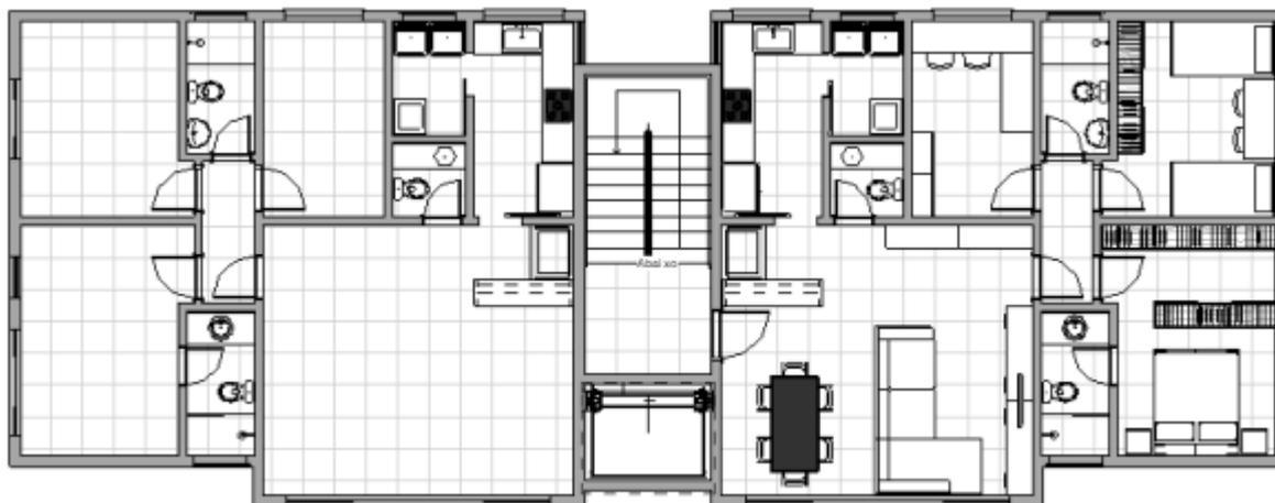
Figura 6 – Planta arquitetônica pavimento tipo (SOUZA, 2019)
