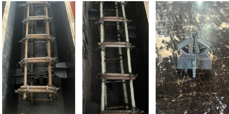
Figura 10 - Armaduras de aço, GFRP e espaçador utilizado (Autores, 2023)
