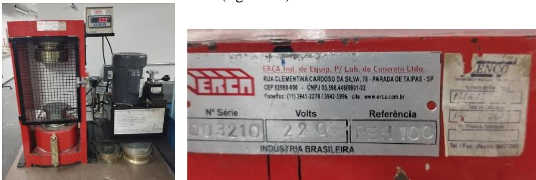
Figura 19 - Prensa hidráulica Erca utilizada (Autores, 2023)
