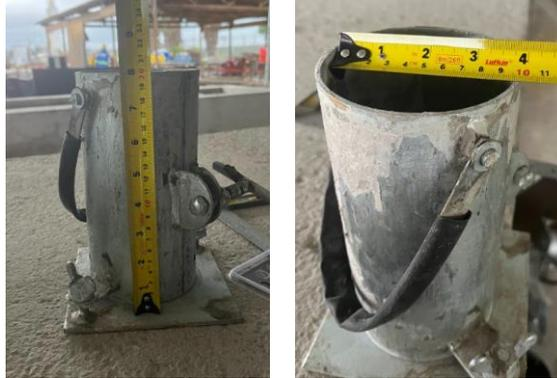
Figura 7 - Forma para moldagem de corpos de prova (Autores, 2023)
