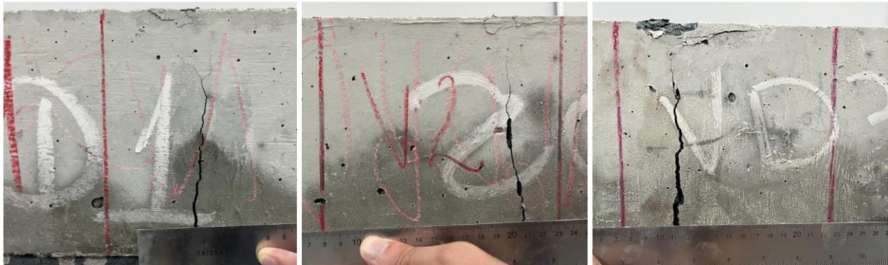
Figura 23 - Ruptura das vigas armadas com GFRP (Autores, 2023)
