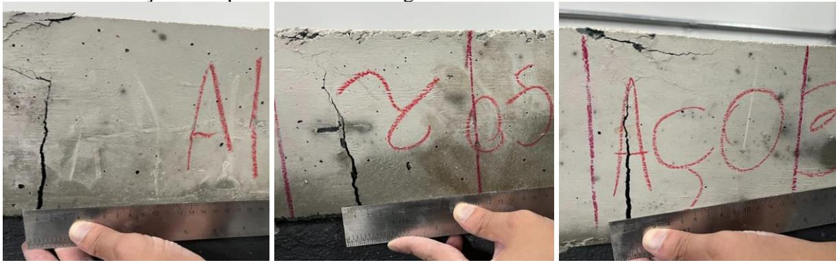
Figura 22 - Ruptura das vigas armadas em aço (Autores, 2023)
