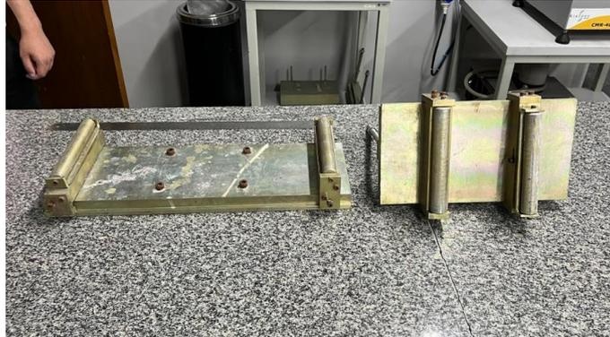
Figura 20 - Aparatos de apoio à viga (Autores, 2023)
