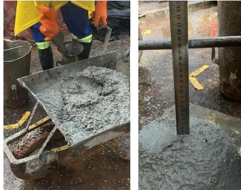
Figura 15 - Abatimento do tronco de cone medido em obra
