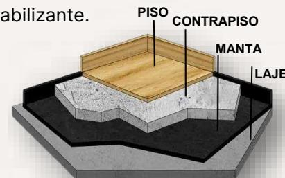
**FIGURA 64 - ILUSTRAÇÃO PISO SOM MANTA ACÚSTICA**
