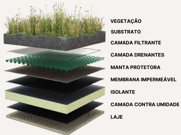
FIGURA 70 - CAMADAS DE TELHADO VERDE
