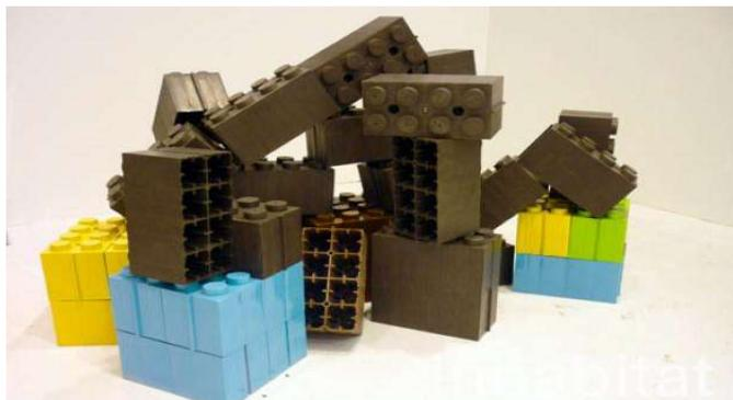
Fig. 6: Blocos de plástico reciclado. Fonte: Sabino, 2014.
