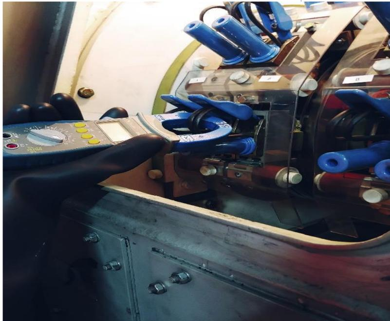
**FIGURA 7** - Alicate amperímetro na escala de corrente contínua
