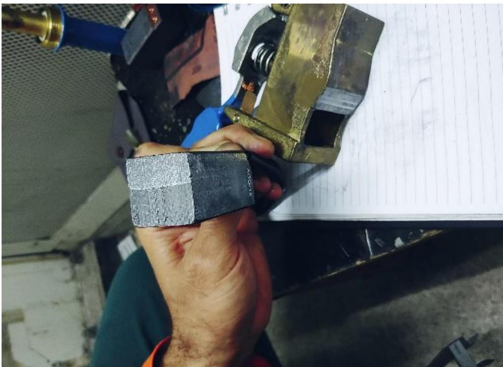
**FIGURA 13** - Desgaste não homogêneo
