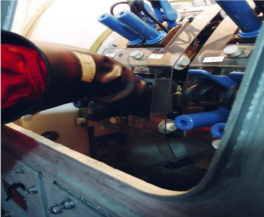
**FIGURA 8** - Posicionamento correto para retirada das escovas.
