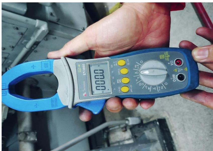
**FIGURA 6** - Alicate amperímetro na escala de corrente contínua
