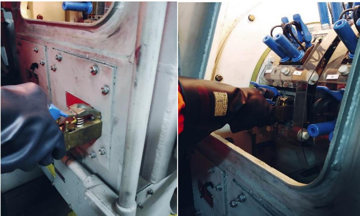
**FIGURA 17 - Pressionar a escova para o interior do porta-escovas, travar na posição fechando a manopla e recolocar a escova no suporte. Recolocar porta-escovas no suporte mantendo o corpo distante da carcaça e sem tocar no suporte.**
