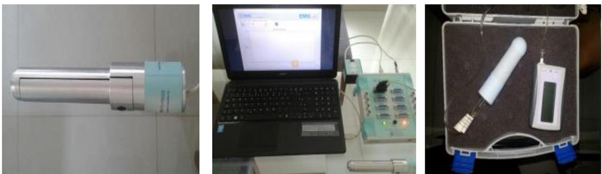
**Figura 10:** Dinamômetro vaginal, eletromiógrafo e perineômetro, respectivamente
